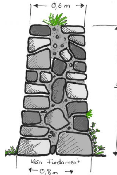
Trockenmauer als kleine Umfassungsmauer auf gesetztem Grund
